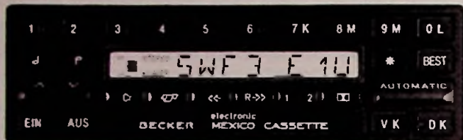
Bild 1: Cassetten-Autoradio mit computergesteuertem Bestsensuchsystem (Becker-Pressbild)
