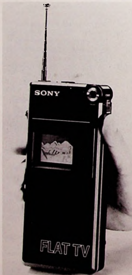
Bild 1: Der erste wirkliche Fernseh-Taschenempfänger FD-200 „Watchman“, mit nur 1,8 Watt Leistungsaufnahme (SONY-Pressbild)
