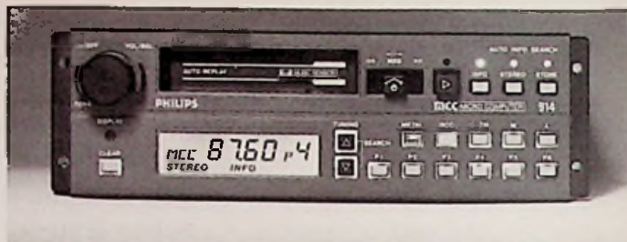
Bild 2: Cassetten-Autoradio mit Sendersuche für 6 UKW-Programme von 60 verschiedenen Sendern (Philips-Pressbild)
